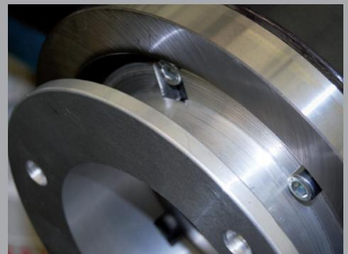
Schmitzringe, angebracht an Platten- und Gummituch-Zylindern, sind hochpräzise geschliffene und gehärtete Stahlringe, die Vibrationen und damit die gefürchteten Kanalstreifen im Offsetbetrieb verhindern.
