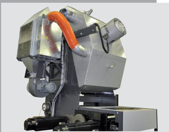
Heißlufttrocknung mit Explosionsschutz für Lösemittelfarben.
